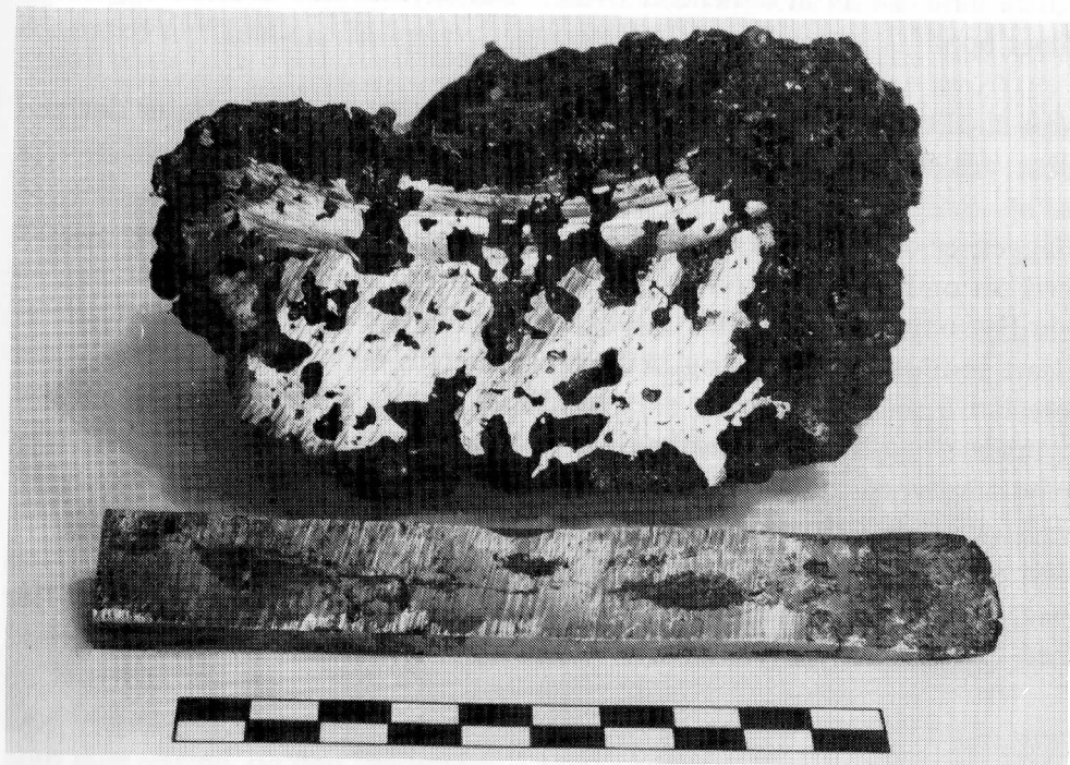
Fig. 13. Snitt av jernluppe på 7.2 kg, framstilt i Budalen 27. august 1991. Emne smidd av luppen.
